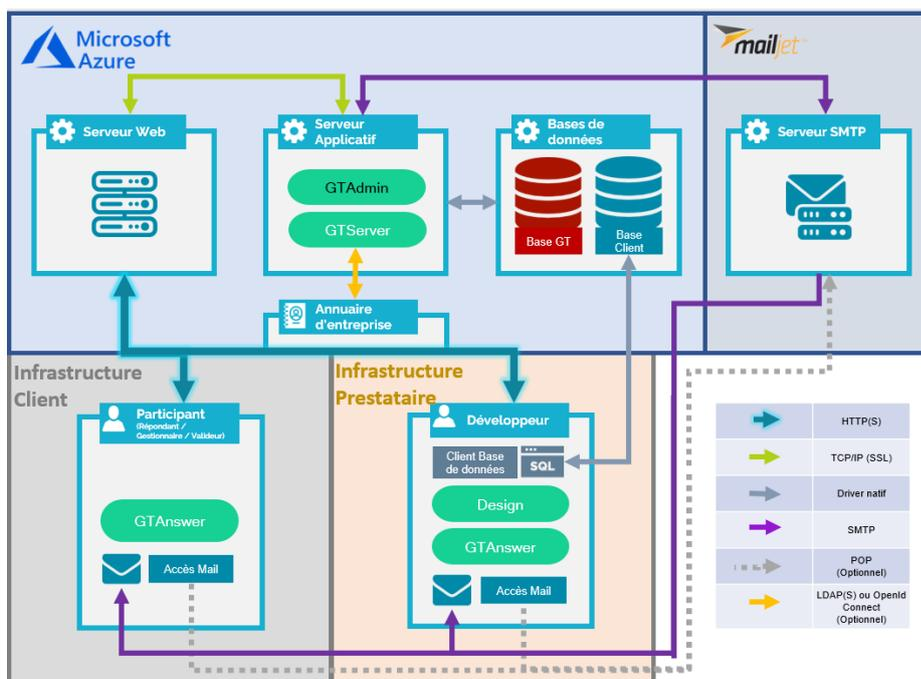
Note 1 : la communication entre GTServer et ses clients (GTAnswer, GTWeb, Automatisation) utilise un protocole propriétaire au niveau de la couche Application (modèle Internet Protocol Suite ou modèle OSI). Le protocole SSL/TLS peut être utilisé pour sécuriser les communications.
